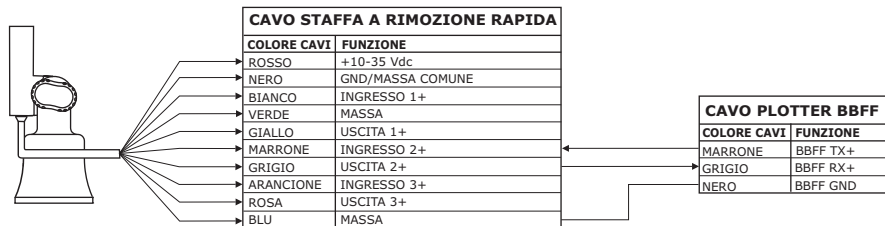
Fig. 4.7 - Connessione Fish Finder per plotter con staffa a rimozione rapida
